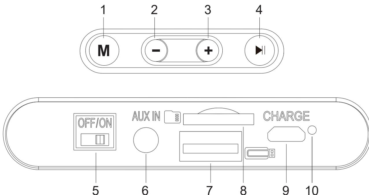
①…短押しでモード切替 / 長押しで LED イルミネーション切替
