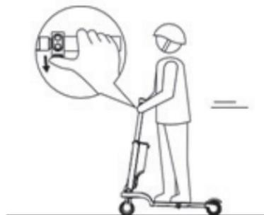
速度を上げる時は、アクセルレバーを押します。減速はアクセルレバーを戻します。
