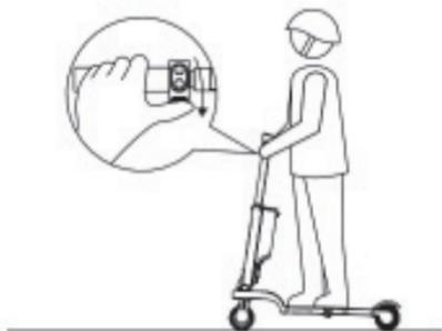
アクセルレバーを戻し、左側にあるブレーキレバーを押して減速し、左足でブレーキペダルを踏みます。
